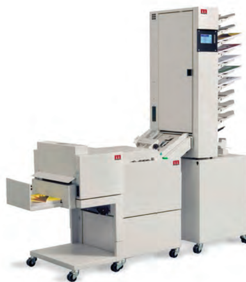
VM 61 з листопідбірником C510 і модулем пласкування корінця 104 в лінії
