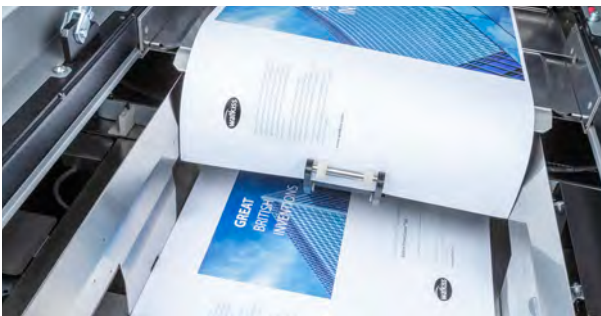
Станція сортування з "тумблером" складання аркушу до станції
