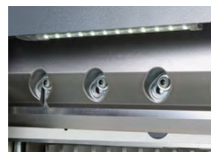
Світлодіодна індикація лінії різання забезпечує достатню ступінь освітлення робочого місця, навіть при загальному слабкому освітленні виробничого майданчика.
