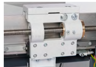
Високоякісний шпindel та напрямні.
