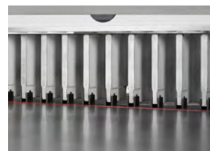
Задній упор (затл) з планками фальш-притиску і пластиковими вставками дозволяє уникнути пошкодження поверхні робочого столу.
