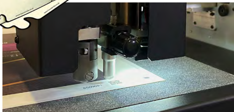
Подвійна інструментальна головка для швидкого різання та бігування включає можливість тангенціального бігування
