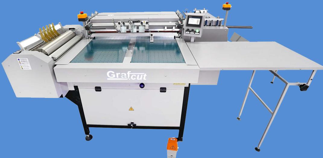
**GC-480 Pro 4** проклеює всі 4 сторони корпусу і кути за один прохід завдяки двом поворотним модулям. Під час процесу все повітря видається назовні.
