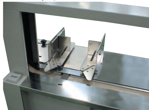
Допоміжна напрямна для м'яких матеріалів допомагає зв'язати конверти, папір для листів тощо (для Tapit WXII, WII+)
