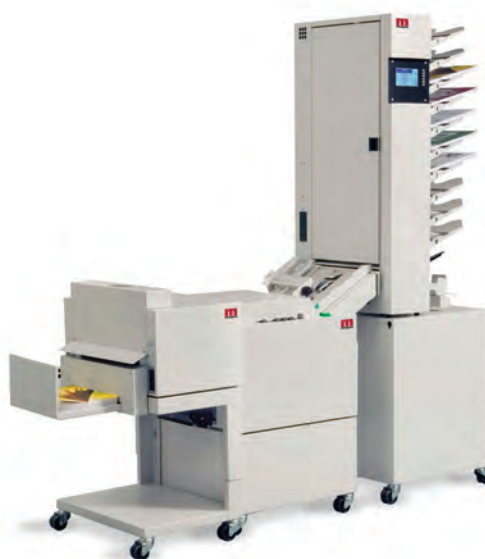
ВМ 61 з листопідбірником С510 і модулем пласкування корінця 104 в лінію
