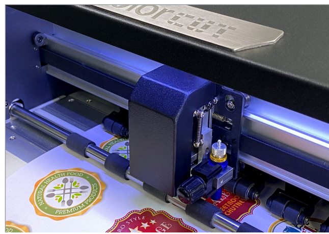
Високошвидкісна інструментальна головка з зусиллям 500 г, точний ріжучий інструмент
