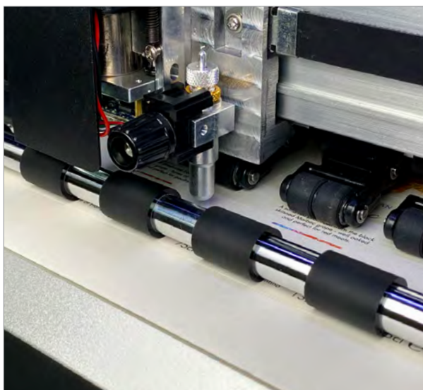
Тримач леза дозволяє змінювати лезо залежно від типу носія
