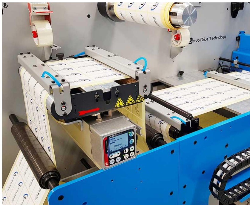
Система рівняння полотна та регульовані столи для склеювання
